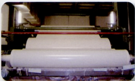
面漆塗裝機 / Finish Coater
