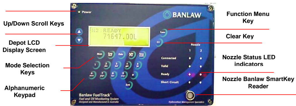
Banlaw FuelTrack Depot
